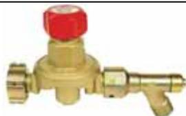
**Express 686** : Détendeur HP propane sortie pression variable : 2 à 4 bar (pression entrée 4.5 à 16 bar). Débit maxi 10 à 12 kg/h. Entrée écrou de bouteille à ailettes 21.8 x 1.814 à gauche. Sortie 3/8" gauche.
