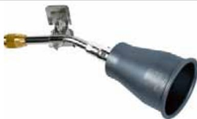
**Express 4639** : Lance d'étanchéité grande puissance (150 kW) air-propane. Tuyère ronde, en acier traité dia 70 mm, pour une flamme torche. Longueur col 130 mm. Brûleur équipé d'un pied de pose démontable et orientable. Equipé de bague d'air permettant un réglage précis de la flamme et une modulation de la puissance.
