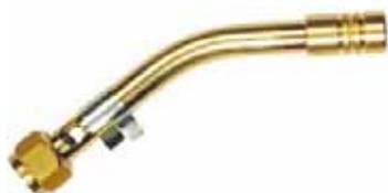
**Express 4642** : Lance de brasage air-propane. Diamètre intérieur tuyère : 13 mm. Brasage fort et tendre à flamme dard, très modulable. Température réglable entre 1200 et 1850°C à l'aide de la bague d'air. Puissance de chauffe 2.2 kW. Alimentation de 1 à 4 bar. Consommation : 180 g/h
