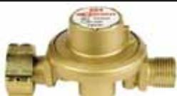
**Express 684** : Détendeur propane sortie 4 bar fixe (pression entrée 4.5 à 16 bar). Débit maxi : 8 kg/h. Garantie 5 ans. Entrée écrou de bouteille à ailettes 21.8 x 1.814 à gauche. Sortie 3/8" à gauche.
