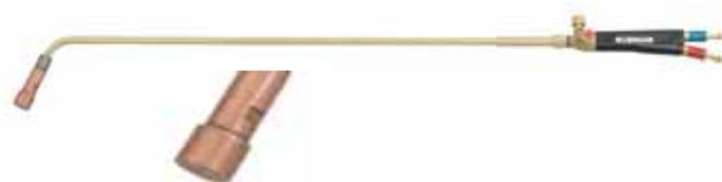
**CHAUFFEUR :** Chalumeau chauffeur oxypropane, livré avec un brûleur de 10kg/heure. Employé pour les gros travaux de chauffage, formage de toutes épaisseurs. Clapets anti-retour incorporés. Poids : 1,40 kg. Longueur : 1080mm.
