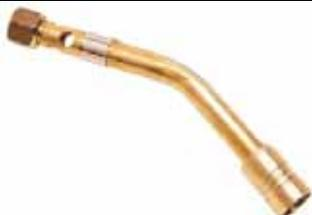
**Express 4643** : Lance de brasage air-propane. Diamètre intérieur tuyère : 17 mm. Brasage fort et tendre à flamme dard, très modulable. Température réglable entre 1200 et 1850°C à l'aide de la bague d'air. Puissance de chauffe 5.2 kW. Alimentation de 1 à 4 bar. Consommation : 380 g/h.
