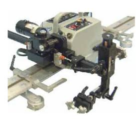
CHARIOT KAT INDEXER: Système d'indexage qui contrôle les mouvements du chariot entre deux butées sur le rail et d'un bras motorisé entre deux butées sur le bras. Le système permet de faire parcourir à la torche une surface complète par des déplacements entre deux butées et à la fin de chaque course, par un indexage précis de la torche. Ceci permet d'automatiser et d'augmenter l'efficacité des opérations de rechargement sur tôles, par soudage, pulvérisation à la flamme,...
