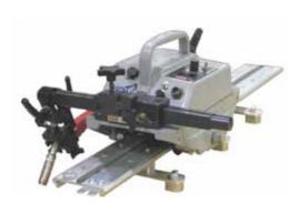
CHARIOT KAT SIMPLE: Le plus souvent utilise en commande manuelle mais peut faire le cycle simple suivant (si équipé de fins de course): Soudage entre fin de course à gauche et fin de course à droite à vitesse de soudage. Retour automatique sur fin de course gauche à vitesse rapide
