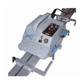
CHARIOT KAT AUTOWELD: Equipé de trois capteurs, deux fins de course et un central et est livré avec les deux butées fin de course). Son cycle standard (mais modifiable) est: Déplacement du fin de course gauche vers la position de départ (capteur central) à vitesse maxi. Soudage entre capteur central et fin de course à droite à vitesse de soudage. Retour automatique sur fin de course gauche à vitesse rapide.
