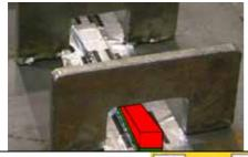
MISE EN PLACE DES CERAMIQUES: Positionner au dessus du joint à souder, la céramique centrée (vous aider de la ligne rouge de guidage si elle existe)
