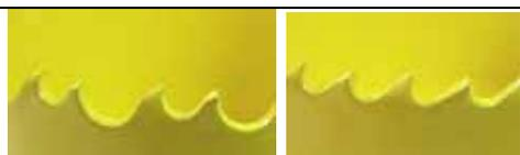
**SCIE-CLOCHE (TREPAN) :** Scie-cloche bi-métal **pas variable** (photo de gauche) pour perçage de tous les métaux courants en chaudronnerie, constructions mécaniques, installations sanitaires et électriques. Profondeur trépan : 35 mm. Grosse denture pas variable à angle positif pour coupe de production exigeante sur moyennes épaisseurs.
