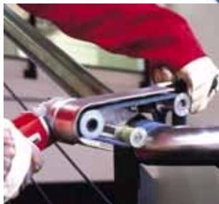
**UTG 9-R** : Idem UTC7-R mais angle de contact jusque 220° pour diamètre jusque a 70 mm. Bande abrasive 30 x 610 mm.
