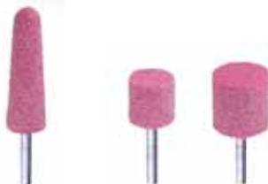
**Meules en corindon rose** sur tige de 6 mm pour ébauche et finition sur métaux ferreux, adaptables sur meuleuses droites pneumatiques et flexibles de perceuses. Vitesse recommandée : 15 à 40 m/s.
