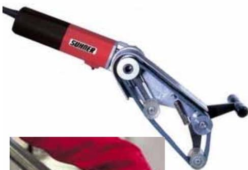
**UTC7-R** : Cette polisseuse 3D spécifiquement conçue pour le travail sur tubes, utilise une bande abrasive (30 x 533 mm) tenue par trois points et formant un angle de contact jusque 180° (diamètre tube inférieur à 45 mm).
