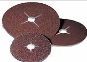
**Fibrodiskettes** : Ces disques de diamètre 125 ou 180 sont constitués d'une toile abrasive (corindon) pour les aciers non alliés et se montent sur un plateau nylon ou autre d'une machine électro-portative.
