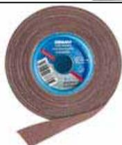
**Rouleaux d'atelier** : Rouleaux de toile abrasive (corindon) extra-souple, largeur 38 mm, longueur 25 mètres. Pour décapage, ébavurage, et polissage de surfaces concaves, convexes, de tubes ou contours sur métaux ferreux et non ferreux. Utilisation manuelle, se plie et se déchire à la longueur désirée. Grains 40, 60, 80, 120, 150
