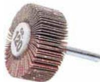
**Polissoir à lamelles** : Roues aux nombreuses lamelles abrasives (corindon) réparties en éventail autour d'un axe d'entraînement de diamètre 6 mm pour utilisation sur perceuse électrique ou meuleuse pneumatique. Permettent polissage, ébavurage, décalaminage, dérouillage, décapage
