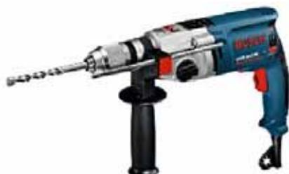
**GSB 21-2 RE** : Perceuse à percussion 2 vitesses robuste et puissante : Carter en métal solide pour une grande longévité, Moteur Bosch à fort couple pour les travaux difficiles (perçage avec foret, perçage avec scie trépan, perçage avec scie cloche, vissage et malaxage), Débrayage de sécurité mécanique Anti-Rotation pour une sécurité de travail élevée
