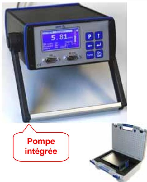
**PRO2PPM** : Moniteur de purge "PRO O2 PPM" spécifiquement conçu pour la mesure du niveau d'oxygène résiduel dans les gaz inertes utilisés pour l'inertage. : de 1 ppm (précision +/- 0.5% de l'échelle de lecture) jusque 20.64 %
