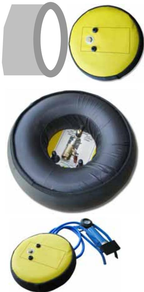
**BOUCHON GONFLABLE ATO** : Il permet d'obturer des tubes, tuyauteries, canalisations béton, conduits, ... de diamètre 50 à 2000 mm et de protéger contre les intempéries, la poussière, les animaux, ..., d'isoler un volume pour inertage, ...
