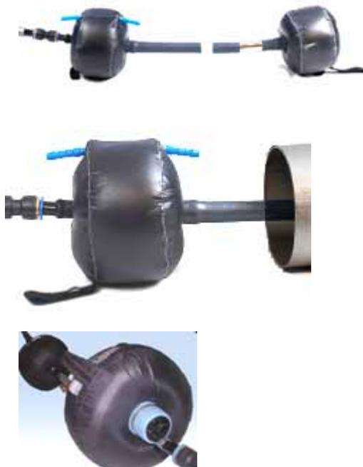
**VESSIES GONFLABLES 1 A 12 POUCES :** Le soudage tube sur tube en acier inoxydable ou autres nécessite un inertage (remplissage des cavités intérieures par du gaz inerte). Celui-ci est indispensable pour éviter tout risque d'oxydation importante (rochage) ou non, qui diminuerait d'autant la résistance à la corrosion de cordon et risquerait de polluer les fluides ou liquides circulant dans les tubes. Les vessies de purge présentent de multiples avantages :
