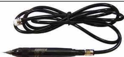
**LGS30** : Stylo à graver à pointe carbure de tungstène pour marquage sur métaux, verre, pierre et plastique : produit un marquage profond et durable. 3 pointes de fin à grossier. Travail sans vibration (30 000 tours par minute). Alimentation pneumatique, 2 m<sup>3</sup> / heure. Poids : 150 grammes
