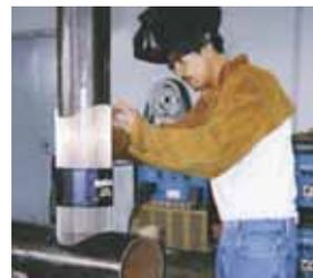
**POINTEAUTUBE :** Ce pointeau se compose d'une structure en Y, d'un cadran gradué sur 180° et d'un niveau. Il permet de réaliser un marquage précis sur un tube, pour une position angulaire donnée.
