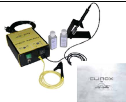
**MARK INOX** : Le MARK INOX est un matériel portatif (170x210x100 mm 4.3 kg, alimentation 230 V mono) de marquage durable sur inox, aluminium, cuivre. Le principe de marquage est une électrolyse durable qui se fait électrochimiquement au travers d'un pochoir type sérigraphie. Le MARK INOX permet de réaliser différents travaux de marquage (étiquettes d'identification, indication des n°s de série,....
