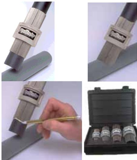
Ce système est destiné au marquage des coupes biaisées et des pénétrations pour les tuyauteries et tubes, sans calcul. Il est constitué d'un ensemble de fils métalliques qui coulisent pour épouser l'intersection des deux tubes. L'opérateur peut ensuite tracer les formes à découper.
