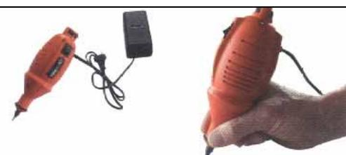
**STYLOGRAVEUR220ET** : Marqueur par **étincelage** pour pièces métalliques fragiles ou celles ne tolérant aucun impact de déformation. L'électrode tungstène (Ø 2 x 25 mm) provoque un arc (6000 flash par minute) qui brunit la matière et qui laisse un tracé lisible et superficiel.
