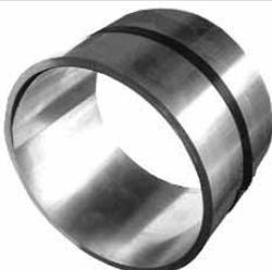
**999HT** : Bande à tracer en acier dépoli, en inox 304 ou 316 L, en laiton (sans aucun marquage) qui s'utilise comme règle, enroulée sur un tube. Dimensions : Largeur 95 à 100 mm (plus petit ou plus grand sur demande), épaisseur 0.20 mm (autres sur demande) – Longueur 5 mètres
