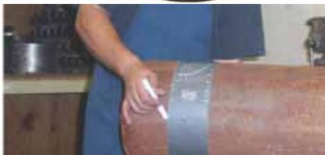
Marquages sur bandes (sauf 150 HT): Inscription en haut et en bas de la bande d'une règle en pouce (graduation en 1/8<sup>ème</sup> pouce) pour mesure de longueur, Rapporteur avec angle 0 à 90° par 2° ; Tableau des valeurs de tangente; Abaques.
