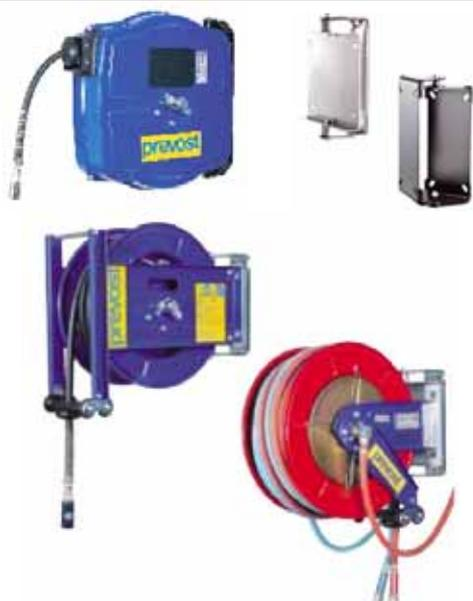
**Enrouleur de tuyau** : Avec les enrouleurs à ressort, vos tuyaux de soudage ou air comprimé ne traînent plus sur le sol et seront préservés de toutes les agressions (chutes d'objet, projections de soudage...). L'outil que vous fixerez en extrémité sera également protégé. Se fixent sur murs ou plafonds - Raccords rapides d'accouplement en extrémité - En option : support orientable.
