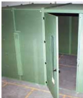
**Cabines de meulage :** composée de panneaux insonorisants Sonic (structure et toit), les parties intérieures sont perforées, les parties extérieures sont pleines. La valeur phonique de réduction sonore est de 29 dBa (selon EN ISO 11957). Coloris standard vert RAL 6011. Hauteur 2552 x Largeur 2130 x Profondeur 3140 mm.
