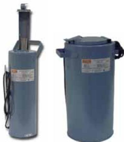
**10A-220** (à gauche) : Alimentation 230V. Equipé avec accessoire d'extraction des électrodes, témoin lumineux. Température moyenne 135°C - modèle de base sans thermostat).
