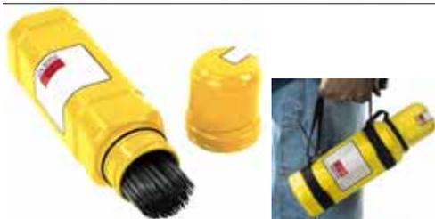
**CARQUOIS450** : Carquois industriel pour stockage à l'abri de l'humidité des électrodes enrobées longueur 350 ou 450 mm, température maxi 120°C (stockage directement au sortir de l'étuve)– couleur jaune repérable de loin – Etanche grâce à joint torique et fermeture par quart de tour– courroie de transport - Permet le transport de 6.5 kg d'électrodes longueur 450 mm – Dimensions : 10x10x48 cm
