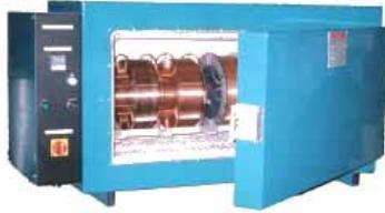
**ETUVE POUR FIL MIG :** Le soudage MIG de l'aluminium de haute qualité nécessite que la bobine soit conservée aux alentours de 60°C. De même, certains fils fourrés nécessitent des précautions.
