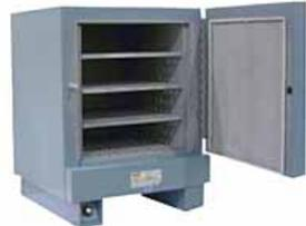
**125-220, 350-220, 350 :** Etuves GULLCO compactes, modulaires, performances élevées (très bonne isolation). Lampe témoin de mise sous tension. Contrôle de la température par thermostat entre 40° et 285°C (40 à 345°C en option sur la plupart des modèles). Alimentation 230 V monophasée (230 / 400V tri sur 350).
