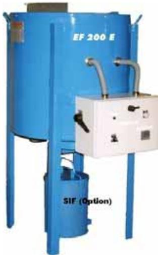
**ETUVES POUR LE SECHAGE DU FLUX :** Ces étuves permettent de sécher le flux (350°C) et évite sa reprise en humidité (120°C). Chauffage assuré par six résistances circulaires. Calorifugeage par laine de roche épaisseur 80 mm. Tableau de commande verrouillable comprenant: un sectionneur, un voyant "sous tension", un bouton "marche arrêt", un voyant "marche".
