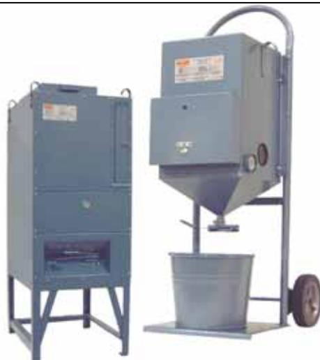
**ETUVE A FLUX CAPACITE 45 KG** (à droite) : alimentation 115 V monophasée, température réglable de 40 à 205°C, thermostat, thermomètre, 400 W – Existe en version simple ou en version avec chariot et seau de récupération
