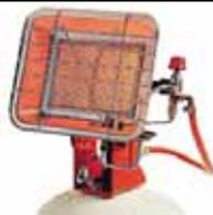
**RADIANTGAZ** : Radiant gaz portable SOLO P823CA pour bouteilles butane ou propane. Les "SOLO" sont conçus pour les professionnels : puissance réglable de 2400 à 4000 Watts, orientables de haut en bas, allumage piezo. Il est équipé d'un contrôleur d'atmosphère pour utilisation en extérieur. Autonomie de 40 à 50 heures avec bouteille 13 kg. Livré complet avec détendeur et tuyau.
