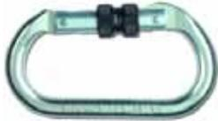
**MOUSQUETON** : Mousqueton en acier à vis de blocage. Longueur 100mm. Ouverture 15mm . Conforme à la norme EN362
