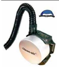
SYSTEME CLEAN AIR: Groupe individuel d'amenée d'air recyclé. Fixation dans le dos du soudeur grâce à une ceinture abdominale large et ergonomique. Permet de prélever l'air au niveau du dos du soudeur, de le filtrer et le diffuser au niveau de la cagoule, à température ambiante. Conforme à la norme EN 12941. Le réglage du débit d'air en 8 positions de 140 à 210 litres par minute accroît le confort du soudeur.
