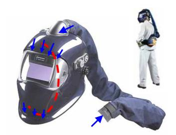
Les cagoules ventilées permettent de ramener de l'air recyclé et filtré, prélevé dans le dos du soudeur (en dehors de la zone polluée) ou venant d'un réseau d'air comprimé, au niveau de la cagoule du soudeur, d'entretenir au niveau du visage du soudeur une légère surpression, empêchant les fumées de soudage de pénétrer dans cette zone.
