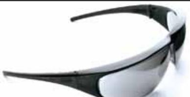
**MILLENNIAMT** : Idem ci-dessus mais monture nylon noire et oculaire polycarbonate traité anti-rayures teinté 2.5 pour filtration solaire (EN172). Bonne reconnaissance des couleurs. Transmission de la lumière visible = 22%. Utilisation : Oculaire teinté pour un usage extérieur lorsque les rayons du soleil et l'éblouissement peuvent causer une fatigue oculaire. Filtration > 99.9% des ultraviolets jusqu'à 385 nm (conforme à la norme EN170). Attention : ne convient pas pour protection soudage.
