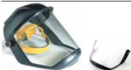
**PROVISO** : Protection faciale du sommet du crâne jusqu'au menton avec serre tête ST804 (avec mécanisme d'encliquetage pour un réglage précis). Ecran panoramique pour une visibilité maximale. Compatible avec des lunettes, lunettes-masques et masques respiratoires. Face relevable, anti-chocs, anti-impact. Conforme EN 166. Poids : 435g
