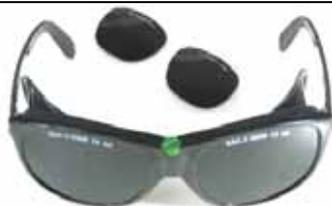
**317S** : Lunettes BASIQUES avec oculaires soudeurs n°5 fixés par vis sur le dessus. Protection contre les radiations optiques dues au soudage à la flamme. 50 g. Conforme EN 175.
