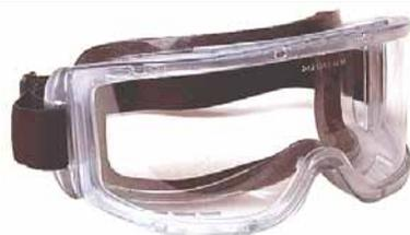
**MASQUECONFORT** : Lunette masque CONFORT en PVC. Micro perforations protégées par de la mousse. Bordure de confort en mousse, élastique avec boucle de réglage étanches aux gouttelettes et aux poussières, pour un confort sans buée. Ecran panoramique, remplaçable (**ECRANMASQUE**), traité antibuée. Compatibles avec le port de lunettes correctrices. Conforme EN166. Poids : 100g
