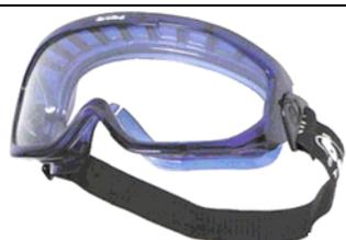
**BLAPSI** : Offrant un champ de vision exceptionnel, BLAPSI bénéficie d'une monture aérée en PVC souple avec goulotte de débordement extérieur pour les liquides, d'une profondeur permettant le port de lunettes correctrices et d'un bandeau réglable monté sur rotule pour faciliter le relèvement sur le casque. BLAPSI permet le port d'un demi masque respiratoire. Poids 115 g. Conforme EN 166 (3/4/9 BT).
