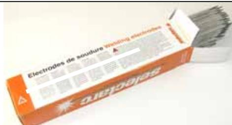
**Electrode enrobée DCS** : Cette électrode enrobée diamètre 3.2 x 350 mm permet la mise en œuvre rapide de gougeage et chanfreinage, sans air comprimé (l'électrode produit un souffle puissant qui enlève le métal fondu). Utilisable en CC ou CA sous environ 200 A. Tenir l'électrode avec un angle de 20° et faire un mouvement de va et vient
