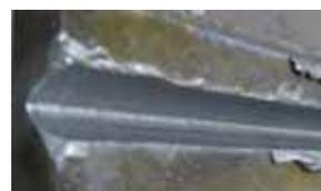
Le gougeage permet d'éliminer du métal (jusqu'à un kilo d'acier par minute). Il est le plus souvent utilisé pour supprimer une zone soudée qui présente des défauts ou pour enlever une partie de la passe de pénétration (celle qui peut présenter des défauts) et qui sera reprise par une passe en soudage : c'est la reprise envers
