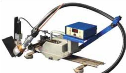
**Chariot KAT équipé en gougeage automatique** : Ce chariot motorisé est équipé d'une descente automatique d'électrodes de gougeage raboutables (que l'opérateur raboute manuellement les unes aux autres) et d'un régulateur de tension d'arc qui permet de réguler automatiquement la distance (à +/- 0.4mm près) entre l'électrode de carbone et la pièce à gouger. *La gouge obtenue est donc très régulière et d'excellente qualité (voir photo à gauche).*
