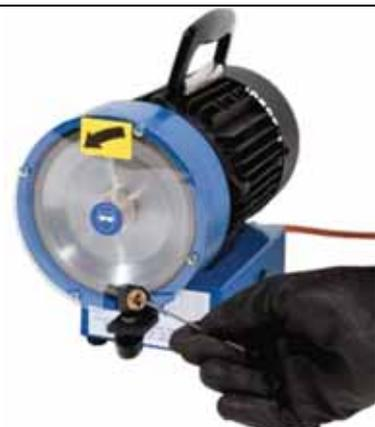
**TEG-3** : Le soudage TIG et plasma nécessitent des électrodes tungstène avec un affûtage parfait. L'**affûteuse d'électrodes tungstène TEG-3** offre cette qualité, jour après jour, à faible coût. La meule diamantée affûte longitudinalement. Ceci évite toute instabilité d'arc ou tout arc parasite que l'on constate lors d'un affûtage circonférentiel.
