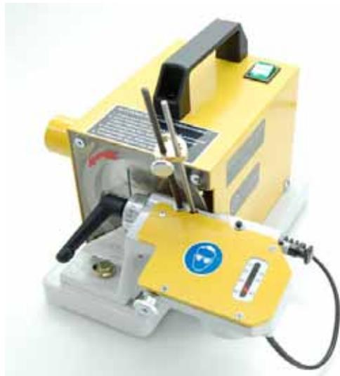
La mise en rotation de l'électrode (325 tours par minute) est assurée par une motorisation électrique. La force de poussée de l'électrode contre la meule est assurée par gravité. Il n'y a pas d'intervention manuelle, ce qui garantit une excellente reproductibilité de l'affutage.
