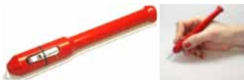
**TIGPEN** : Crayon porte fil d'apport. Outil idéal pour introduire le fil d'apport manuellement et en continu pendant le soudage. Utilisation facile : Introduire le fil d'apport (dia 0.8 à 3.2 mm) par l'arrière et le déplacer à l'aide de la molette (couleurs différentes suivant appros)
