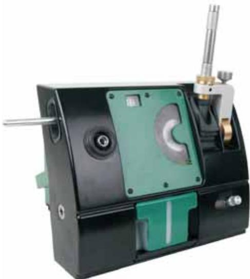
**TIPTG** : Affûteuse d'électrode tungstène à bain liquide : Affûtée dans un liquide de refroidissement combiné avec une vitesse d'affûtage élevée de la meule diamantée, la surface de l'électrode tungstène est égale et brillante (aucun échauffement excessif).
