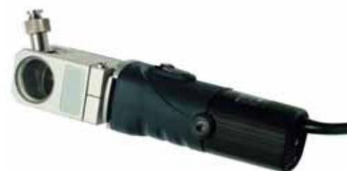
**NEUTRIX** : Affuteuse d'électrode tungstène, portable, ergonomique, très légère, offrant des angles d'affutage (15 à 180°, gradué de 5 en 5°) très précis. La chambre d'affûtage est fermée avec un verre d'inspection de sorte que l'affûtage puisse être observée mais que les poussières de meulage soient collectées et retenues dans un filtre (dessin en bas à droite).
