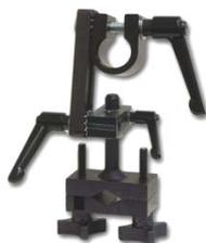
**GK-165-145** : Support de torche simple articulé permettant une rotation de torche à 360° dans toutes les directions. Livré avec un support de torche isolé dont les mâchoires permettent un serrage entre 16 et 38 mm. Se monte sur un axe dia 28.6 mm.
