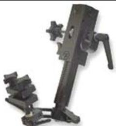
**GK-165-74-2** : Support de torche poly articulé permettant une rotation de torche à 360° dans les deux directions, un réglage en hauteur sur 127 mm. Livré avec un support de torche isolé dont les mâchoires permettent un serrage entre 16 et 38 mm. Se monte sur un axe dia 28.6 mm.
