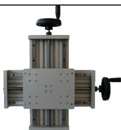
**BIG 1** : Glissière manuelle simple, charge maxi 70 kg à 500 mm, course utile 190, structure en aluminium extrudé, guidage de précision, déplacement par vis trapézoïdale et noix bronze. Poids de la glissière : 6 kg
