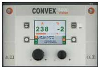
Panneau CONVEX VISION avec écran graphique couleur – Le CONVEX VISION permet de bloquer les programmes en laissant un pourcentage d'accès au soudeur sur chaque paramètre
