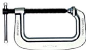
**PRESSE EN C** : Corps en acier forgé de haute résistance, nervuré, zingué. Puissance de serrage accrue. Col de cygne profond. Rotule à la vis de serrage, striée, zinguée. Patin de serrage fixe rainuré.
