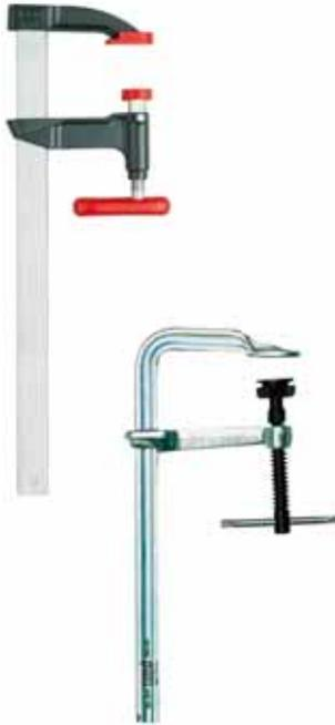
**SERRE-JOINT A POMPE SERIE AP** : Rail en acier étiré à froid, cranté sur chants, zingué. Valet et coulisseau en fonte à graphite sphéroïdal de haute résistance. Couple de serrage très puissant. Protection sur mors.
