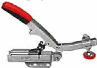
**SAUTERELLES** offrant ouverture et fermeture par simple manœuvre du levier. Grand effort de serrage jusque 2500 N pour un faible effort manuel sur le levier ergonomique BIMATIERE. Verrouillage total et reproduction du serrage à l'infini, ouverture à fort dégagement permettant un enlèvement facile de la pièce
