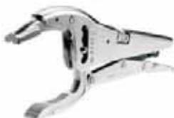
**505** : Pince étau à réglage par molette et boutonnière 5 positions. Serrage entre mors largeur 17 mm toujours parallèles sur carré 70 mm max et rond 135 mm max. Poids 720 g.
