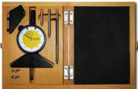
**JAUGE3** : Jauge permettant la mesure très précise (1/100<sup>ème</sup> de mm) de la profondeur des caniveaux, cratères, de la surépaisseur d'un cordon bord à bord. En coffret bois avec sabot d'appui, 3 rallonges et deux micro sondes (dia 0.6 et 1.6 mm)
