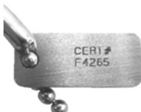
La **GAUGE11SUPETAL** est livrée avec un certificat d'étalonnage raccordé à des étalons primaires du NIST (équivalent USA du COFRAC français, lié par accords de reconnaissance mutuelle). Le n° du certificat est gravé au laser sur une plaquette attachée aux lames.
