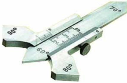
**CALIBRE5142** : Mesure très précise sur vernier au 1/10<sup>ème</sup> de mm de la côte "a" des cordons de soudage (jusque 20 mm). Permet aussi de mesurer au 1/10<sup>ème</sup> la surépaisseur des cordons bord à bord. Permet de quantifier l'angle des chanfreins (60, 70, 80, 90°)
