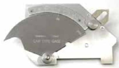
**GAUGEMG-8** : Jauge très complète, précision correcte, permettant de mesurer (en mm ou en pouce) :
