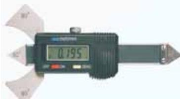
**5142DIGIT** : Idem jauge 5142 mais avec affichage digital résolution 0.01 mm (précision 0.03 mm), température de fonctionnement 0 à 40°C humidité max 80% - fonctionne sur pile SR44, 1.55V
