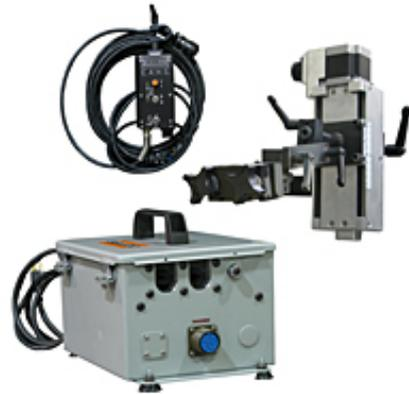
**Système AVC** (Arc Voltage Control) qui mesure la tension de l'arc (proportionnelle en TIG) à la distance entre la pièce à souder et l'électrode et qui permet de la maintenir constante (la torche TIG était positionnée sur une glissière motorisée verticale).
